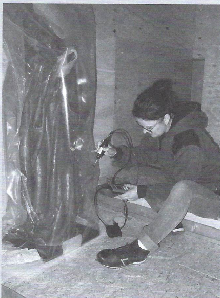
An Breyne van de firma Patrimoon meet het zuurstofgehalte in de luchtdichte verpakking van een houten engelenbeeld.
